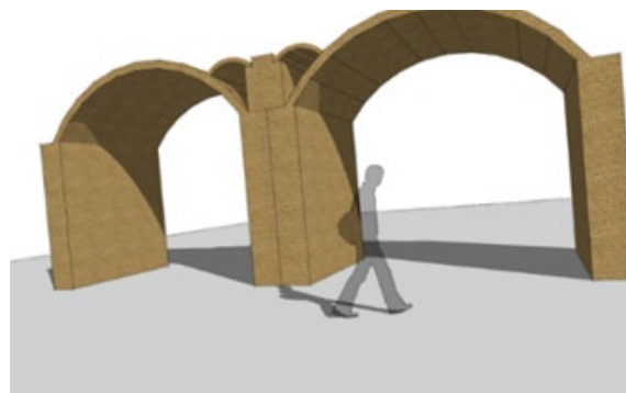
شکل ۳۷. سه‌بعدی از محل مناسب قرارگیری کنو روی شکن‌گاه و سه‌بعدی محل نامناسب قرارگیری کنو روی ایوارگاه منبع: نگارندگان
